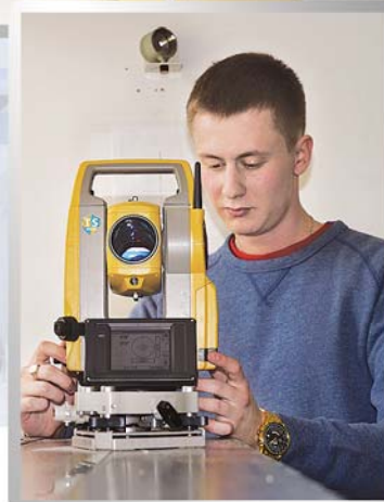
ЭТАП 6. ПРОВЕРКА ДАЛЬНОМЕРА
