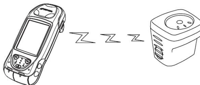
Рис. 3-7. Подключение BR-1 к GRS-1 через Bluetooth
