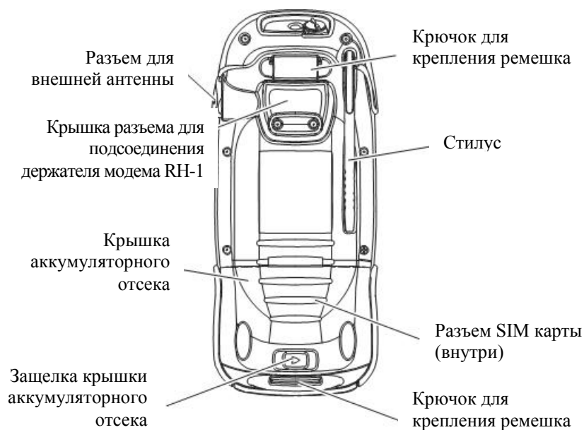
Рис. 1-4. Задняя панель GRS-1
