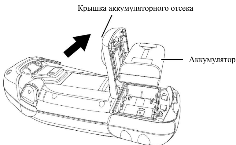
Рис. 2-2 Установка основного аккумулятора
