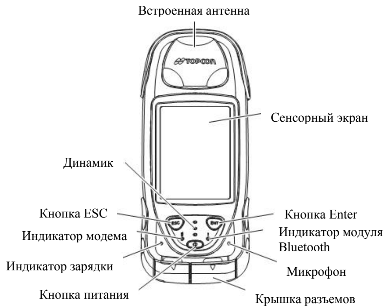
Рис. 1-3. Передняя панель GRS-1
