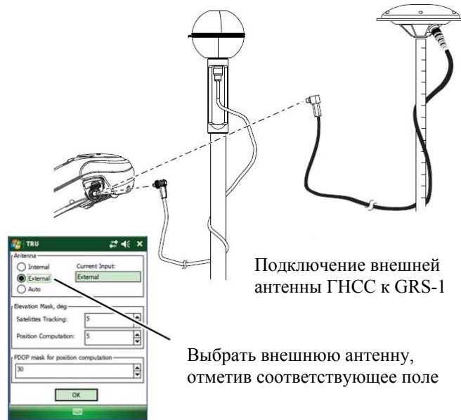
Рис. 3-6. Подключение антенны PG-A1/PG-A5/MG-A8 к GRS-1
