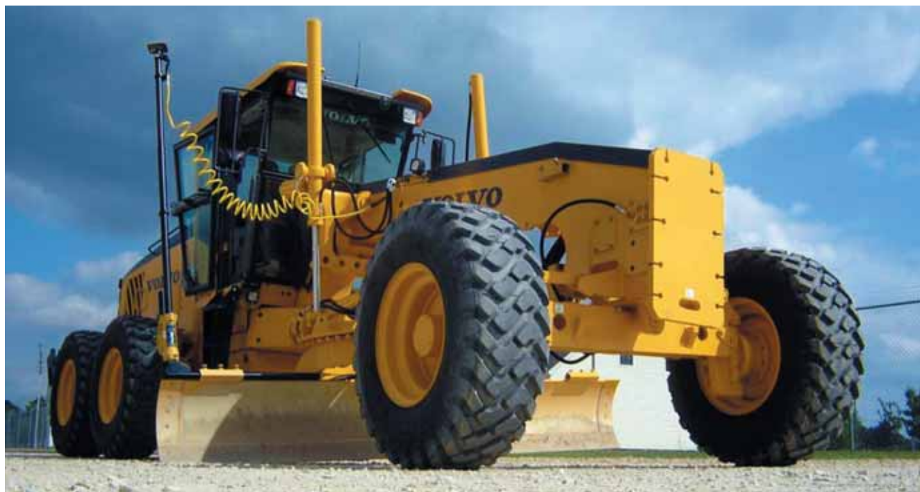
Рис. 2. Автогрейдер, оснащенный системой автоматического нивелирования Topcon 3D GPS/GLONASS
