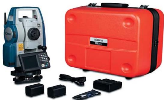
Моторизованные электронные тахеометры серии DX – новый уровень в развитии электронных тахеометров. Эти приборы оснащены быстрым и мощным дальномером, что позволяет получить достоверный результат за минимальное время с максимальной точностью. В безотражательном режиме тахеометры серии DX позволяют измерять расстояние до 1000 м, а измерения на призму типа AP выполняются на расстоянии до 6000 м.
