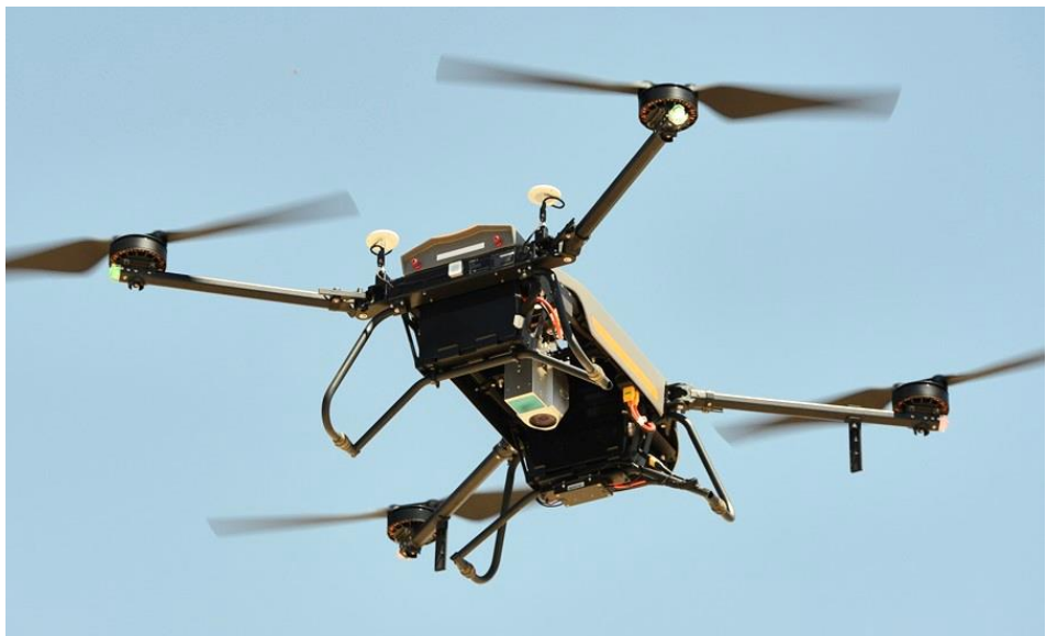
Рисунок 2. БПЛА BV4 и лидар AA450 выполнение съёмки рудника
