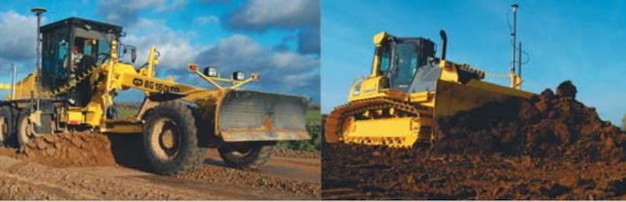
**ГНСС технология** – для позиционирования рабочего органа машины используются измерения по спутниковым сигналам систем ГЛОНАСС и GPS. Для осуществления оперативного контроля спутниковая система работает в режиме реального времени (RTK).
